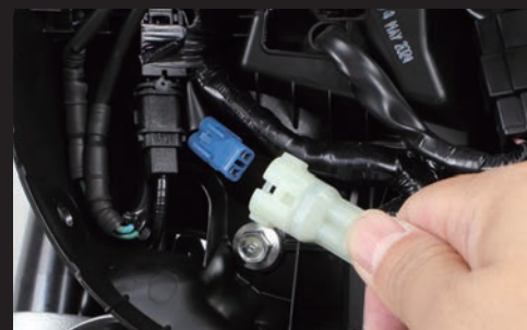
対象車両ヘッドライト内 純正サービスカプラーにカプラーオンで取付可能
