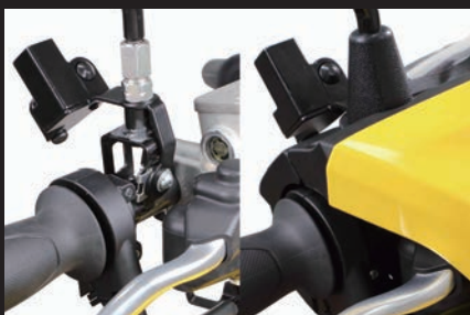
防犯効果を高める固定ステー構造 ステー固定イメージ 左:カウル無し 右:カウル有り
