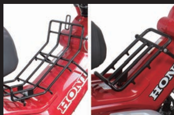
SP武川製センターキャリア重量比較 左: Φ7mm スチール製(従来品) 約940g 右: Φ12mm アルミ製(本製品) 約510g
