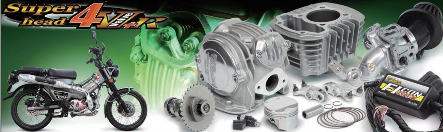
■スーパーヘッド4V+Rコンボキット145ccは、スーパーヘッド4V+RボアアップキットにF1コン TYPE-X(インジェクションコントローラー)、ビッグスロットルボディキット Φ28、大容量フューエルインジェクター(G-1)、エアフィルターキット、#8スパークプラグが付属しています。
