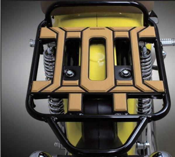
パッドの裏側にある両面テープを剥がし、貼り付けるだけの簡単装着!!
