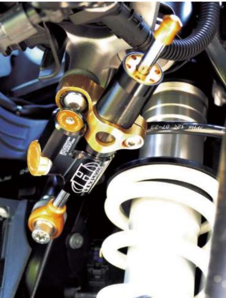
車体への取り付けはステアリングダンパー本体(正ピロボール/55mm)と車種専用ステーが必要です。
