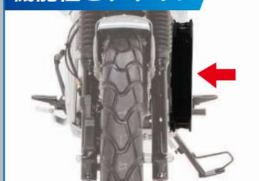
フィッティングを内側に配置し、幅を最小限に抑えた設計。
