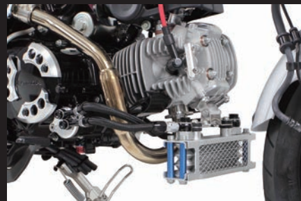
3フィン4オイルライン装着写真
