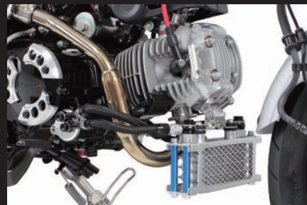
4フィン5オイルライン装着写真
