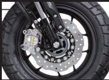
モンキー125 (純正ブレーキホース) SP武川製フロントキャリパーブラケット フロントディスクローターの同時装着
