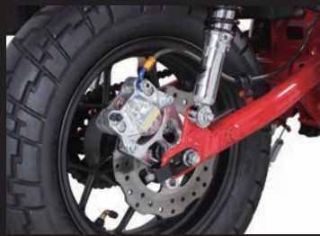
モンキー125 (SP武川製ブレーキホース) SP武川製リアキャリパーブラケット リアディスクローターの同時装着
