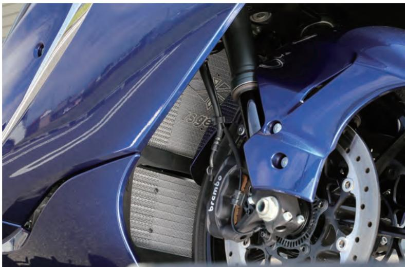
フロントタイヤから巻き上げた小石などによるラジエターへのダメージや、昆虫などによるラジエターフィンが目詰まりを最小限に抑えます。特に小石などの巻き上げが集中するセンター部は、細かいメッシュデザインにすることで確実にラジエターコアをガードし、両サイド部には通気性を優先した大きめのオリジナルメッシュパターンで、保護性能と冷却効率を高次元で両立しています。製品素材には0.8mmのSUS304を使用、エッチング加工によるアールズギアオリジナルデザインのメッシュパターンをベースにアールズギアロゴマークを配置し、ドレスアップ効果と実用性を兼ね備えたコアガードが完成しました。
