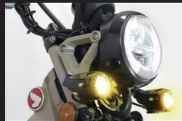
装着写真(取付け位置:Bタイプ/イエロー点灯)
