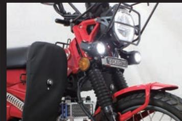
装着写真(取付け位置:Bタイプ/点灯)
