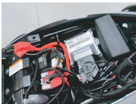
配線の接続先は、シート下のECUカプラーハーネス。
