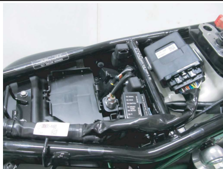
配線の接続先は、シート下のECUカプラーハーネス。
