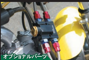
インラインセンサーモジュール ※オイルクーラーキット装着車用
