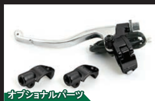
クイッククラッチレバー レバー側で遊びの調整が可能
