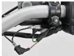
ブレーキスイッチとフレームのボルトに共締めするだけの簡単取り付け。メインキー連動でバッテリー上がりの心配もありません。
