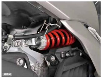
ノーマルサスペンション取付長をロング化 (320→330mm) し、有効なサスペンション ストロークを確保。サスペンションストロークを伸ばしたことにより、初期作動はギャップ 吸収性が向上し、素晴らしい路面追従性を実現。サスペンションストロークの奥でもしっ かりと踏ん張る絶妙なバネレートと減衰特性に設定し、スポーツ走行や高速走行等高荷 重がかる状況でもノーマルをはるかに超える安定性を発揮します。
