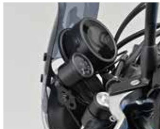
VELONA電気式タコメーター φ48 9000rpm (44198) + タコメーター取り付けステーセット (29987) 装着例
