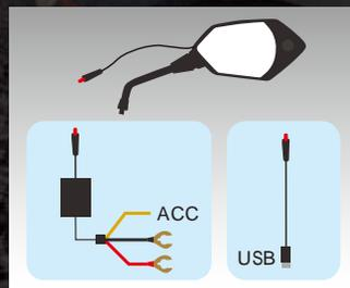
給電方法は2パターン、車体電源ACC連動、もしくは、既に取付けられている5VのUSB電源でも起動可能。
