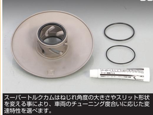
スーパートルクカムはねじれ角度の大きさやスリット形状を変える事により、車両のチューニング度合いに応じた変速特性を選べます。
