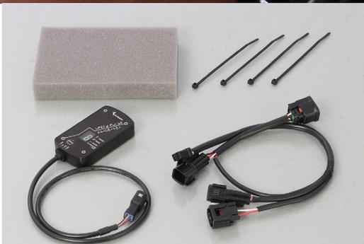
スプロケットの丁数組み合わせ変更や、タイヤサイズ変更で生じるスピードメーターの速度表示誤差を補正するアイテムです。取り付けはコネクタを外し割り込ませるだけ、ハーネス加工は行わない親切設計です。
