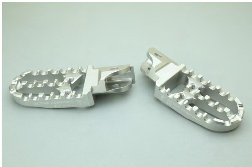
バイク乗車時の自然な足首の角度にフィットするように、ステップ上面を適正な角度にアジャスト。ノーマルステップに対して18度の前傾角度をつけ、さらにステップ高を8mmダウンさせて走行乗車時に足首及び、膝の角度を自然な角度にすることで操作性UP、疲労軽減に貢献します。
