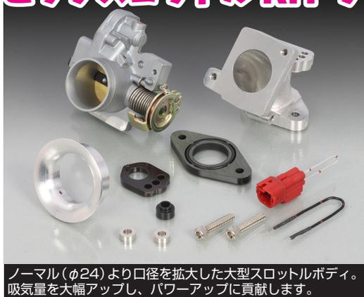
ノーマル(φ24)より口径を拡大した大型スロットルボディ。吸気量を大幅アップし、パワーアップに貢献します。
