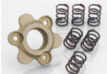
強度アップしたジュラルミン製クラッチリフターに加え、強化クラッチスプリングを付属させた SET です。過酷な使用条件では脆弱なノーマルクラッチリフターと比べて耐久性を向上。クラッチの滑り、タシの少ないスムーズなクラッチワークが可能になります。クラッチスプリングはノーマルと比べ約60%アップの強化型クラッチスプリングです。また、ノーマルスプリングと3本ずつ併用させる事で約30%アップとする事が可能です。
