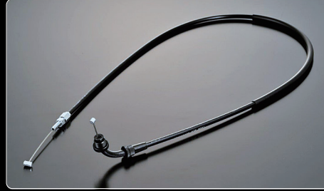
■583-S75 純正品番：58300-49500/58300-11491の対応品 スーパーローフリクション・ステンレス スロットルワイヤー 適応車種：GSX750S (国内GS75X) /GSX750SS (国内GS75X) ※各種ケーブルを組み込み後にハンドルを左右に目いっぱい切ってケーブルがどこにも接触せず引っぱられていないことを、ご確認ください
