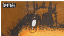
錆付いたガソリンタンク内部
