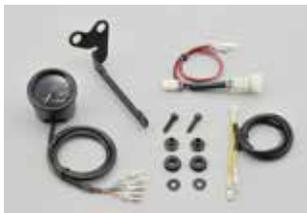
純正スピードメーターの左側に、小径の「VELONA」φ48タコメーターをバランス良く装着できます。タコメーターは、9000rpmブラックボディ/ブラックパネル。取り付けステー、専用ハーネス付属でボルトオン装着が可能です。メーターステーは防振対策のためラバーマウントを採用しています。
