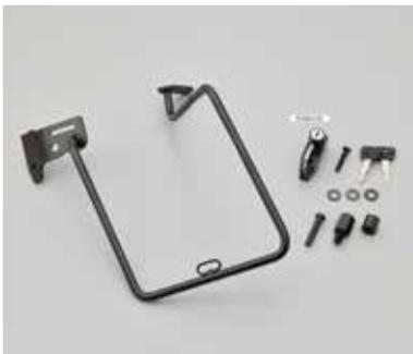
サドルバッグの安定性を高め巻き込みを防ぐサポートバー。専用設計で純正リアキャリア、当社クラシックキャリア (27523) との相性も抜群。ヘルメットホルダー付きなので、サドルバッグを装着してもヘルメットロックが可能です。スッキリしたデザインなのでバッグ非装着時でも、目立ちません。固定用ボルトがオフセットしているので社外リアショックとの併用も可能です。
