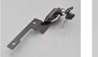
ヘルメットホルダーが標準装備されていない車両にボルトオンでヘルメットホルダーが取付可能。左側タンデムステップホルダーと共に簡単装着。カギは2本付属。
