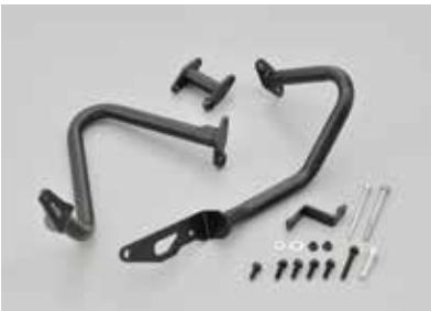
シンプルなパイプレイアウト。メインパイプはΦ28.6を採用。転倒時の車両のダメージを軽減するエンジンガード。入念な設計検討により、車体保護と深いバンク角確保をバランス良く両立。取付時間短縮を考慮したセパレート構造(右側)によりマフラーを取り外すことなく、エンジンガード取付が可能。不必要に目立たないマットブラック塗装済み。
