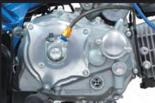
NEW 油圧式アルミ削り出しクラッチカバー
