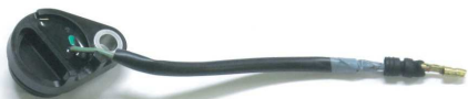
モンキー125/グロムのニュートラルスイッチ ※ニュートラルの線しかない為ギヤ表示不可
