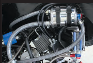
装着写真(シラウドを外した状態) 弊社製オイルクーラーキット同時装着可能
