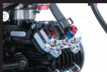
弊社スーパーヘッド4V+R用 ヘッドブリーザー(標準装備)
